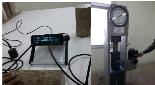
Gambar 6. Benda uji diuji dengan menggunakan UPV (kiri) dan UTM (kanan)
