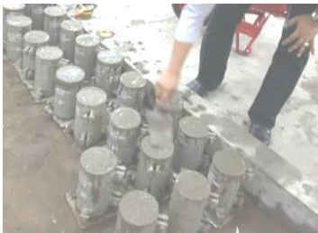
Gambar 4. Permukaan beton diratakan
