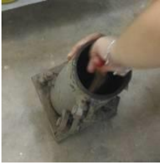
Gambar 2. Bekisting diolesi dengan minyak gemuk / grease
