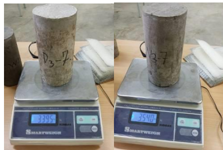
Gambar 5. Benda uji ditimbang
