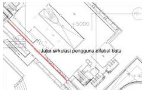
Gambar 4. Jalur sirkulasi pengguna difabel buta sangat dekat sisi bangunan dengan jendela terbuka
