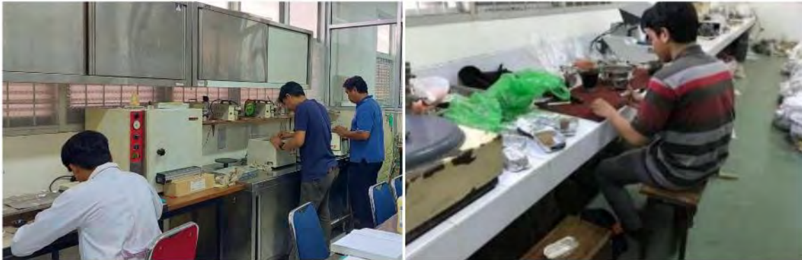
Gambar 7. Kegiatan pembelajaran pembuatan sayatan tipis dan poles bijih kepada mahasiswa Tugas Akhir.
