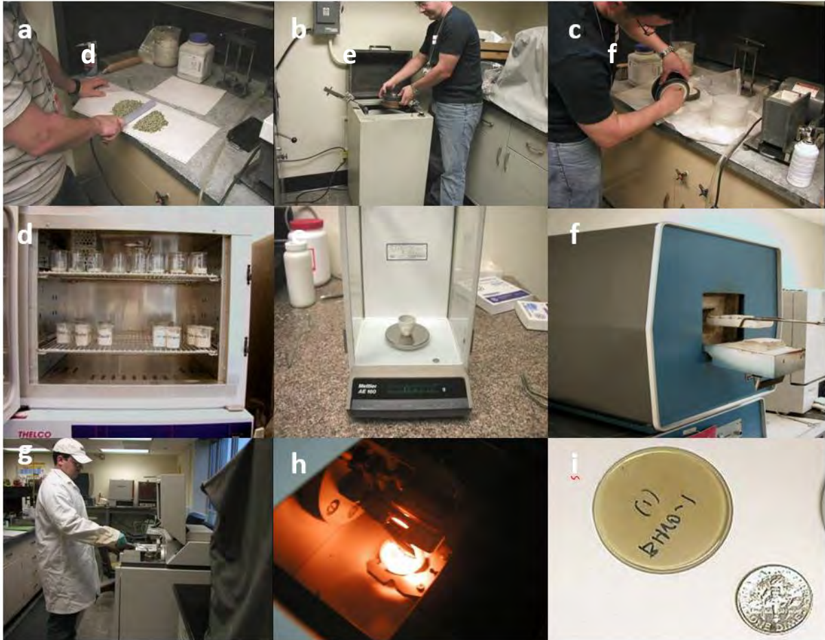
Gambar 2. Contoh preparasi sampel untuk tipe sampel glass bead : a) Pemisahan sampel setelah crusher , b) Powdering sampel, c) Pengeringan sampel, d) Mixing alkali flux , e) Pengeringan sampel, f) Timbangan digital, g) Pengeringan sampel pada suhu 1100°C, h dan i) Sampel dan alkali flux di masak pada suhu 1100°C, g) Contoh sampel glass bead
