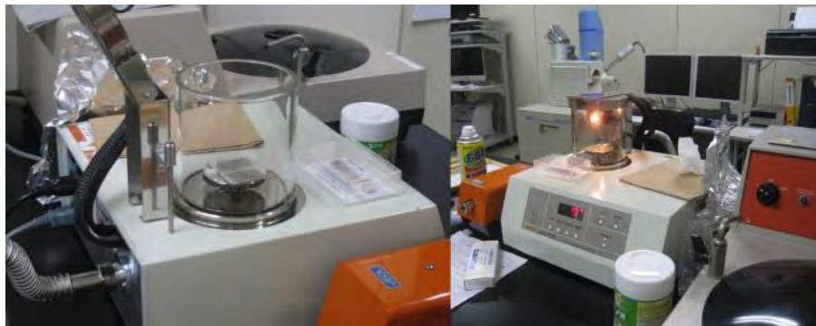
Gambar 5. Vacuum evaporation coater untuk carbon coating
