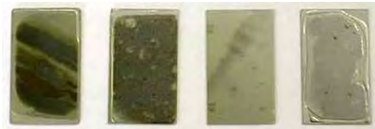
Gambar 2. Contoh standard ketebalan thin section (menipis dari kanan ke kiri), ketebalan sampel minimal < 0,3 mm.
