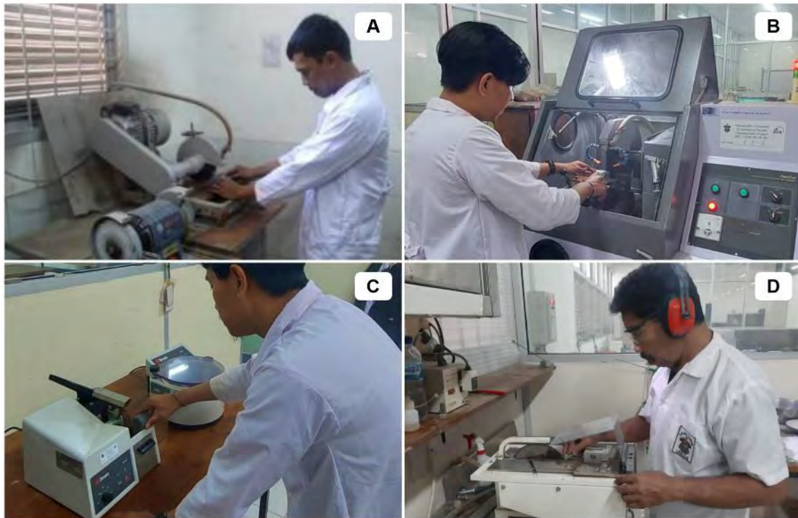
Gambar 3. A) Pemotong kasar batuan; B). Pemotong batuan tipe Abrasive Cut-Off Machine Precicut FTC-305 MSV; C). Alat pemotong batuan Miniton Stuers untuk thin section khusus fluid inclusion , D) Jenis pemotong halus untuk sayatan tipis fluid inclusion (MC-100, Maruto).
