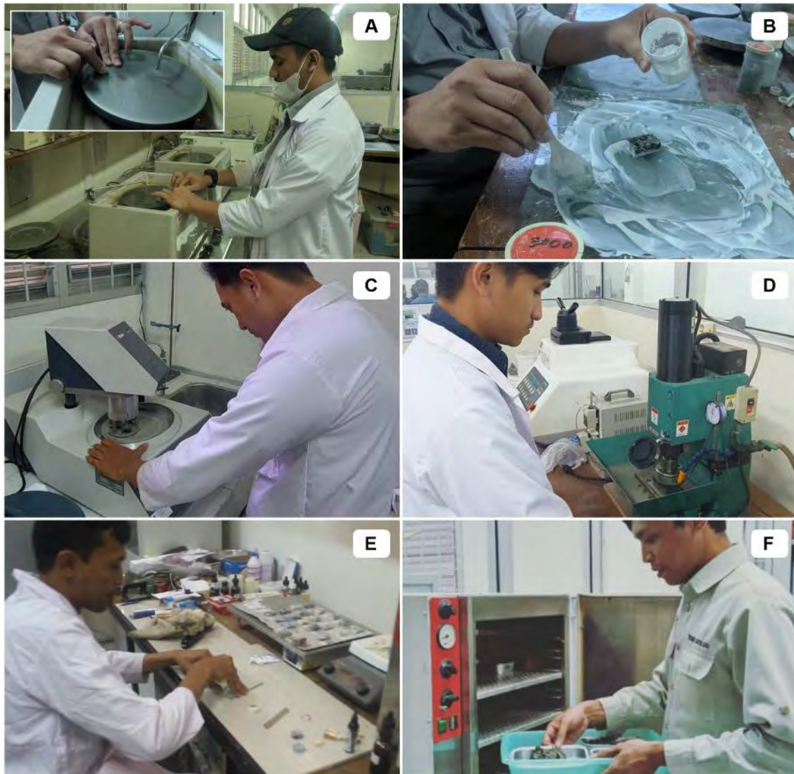
Gambar 4. A) Alat lapping mesin untuk menghaluskan permukaan batuan (ML-110 NT); B) Kegiatan pemolesan dengan menggunakan silicon carbide ; C-D) High polishing thin section for microscope ; D) Alat khusus untuk grinding thin section (MC-101, Maruto); E) Kegiatan perekatan thin section dan Oven jenis flat pada suhu maksimum 80°C; F) Oven jenis tertutup untuk pemanasan sampai 200°C.
