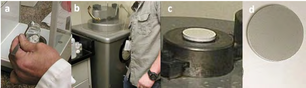
Gambar 3. Contoh preparasi sampel untuk tipe pressed pellet : a) Timbangan digital, b) Hydraulic presser machine , d) Specimen holder , pressed pellet sampel
