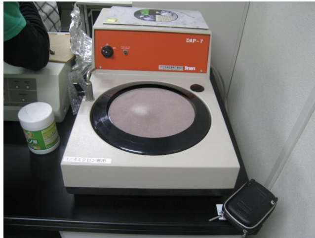
Gambar 4. Mesin untuk fine polishing atau lebih dikenal dengan diamond poles
