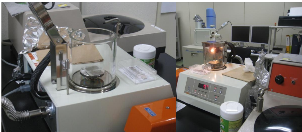
Gambar 5. Vacuum evaporation coater untuk carbon coating
