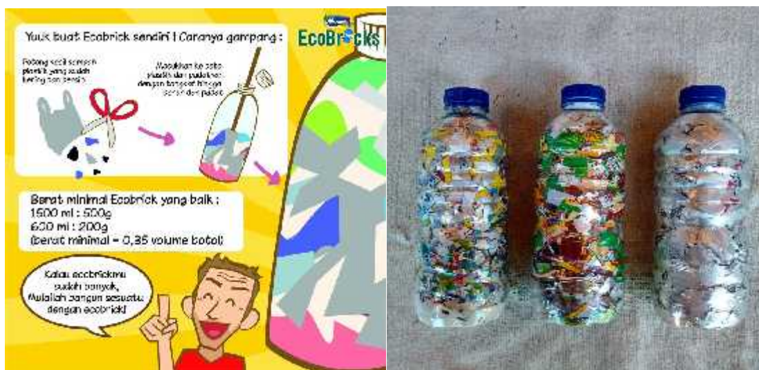
Gambar 3. Cara pembuatan ecobrick
