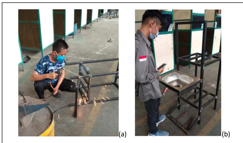
Gambar 2. (a) Proses pengelasan SMAW, dan (b) Pembuatan kerangka alat dan pemasangan wastafel
