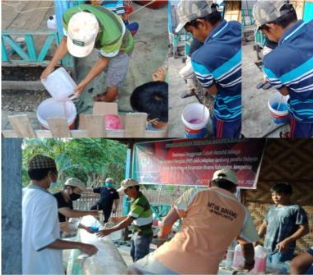
Gambar 7. Proses Pencampuran Bahan Resin, Aerosil dan Pewarna pada Pelapisan Kulit Lambung Perahu (Dokumentasi 2021)
