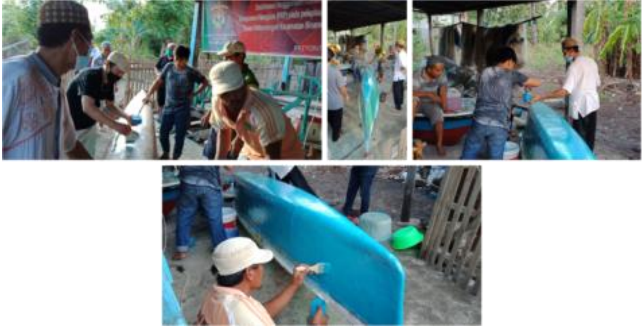
Gambar 8. Proses Pelapisan Kulit Lambung Perahu dengan Resin Aerosil Pewarna Katalis (Dokumentasi-2021)
