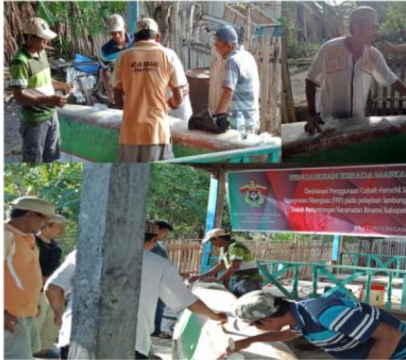
Gambar 6. Proses Perbaikan Kerusakan Kulit Lambung Perahu dengan Pelapisan Roving Resin Katalis (Dokumentasi-2021)
