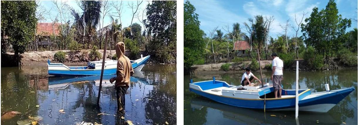
Gambar 8. Proses Pengujian *Inclining test*
