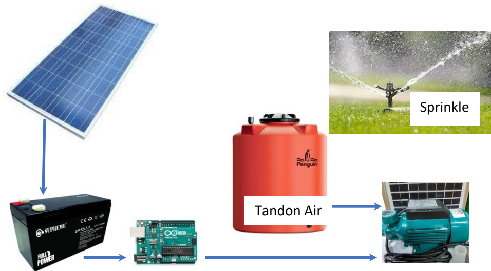
Gambar 1. Sistem Irigasi Otomatis Berbasis Tenaga Surya
