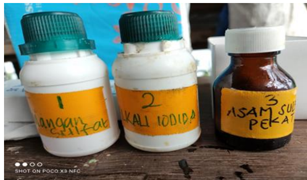
Gambar 3. Reagen-reagen kimia untuk mengikat Oksigen Terlarut (DO)
