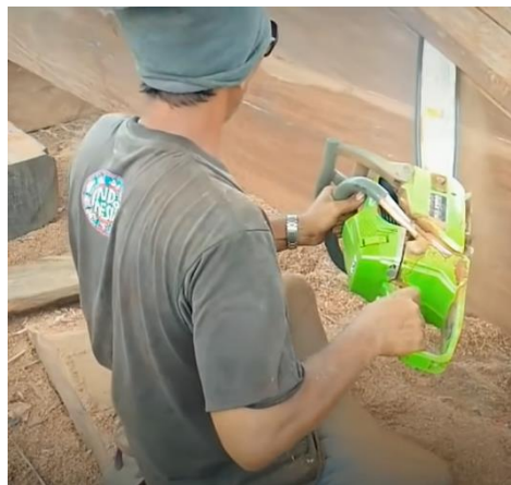
Gambar 2. Salah Seorang Pengrajin Menggunakan Peralatan Mesin Gergaji Listrik Untuk Memotong Permukaan Kayu pada Salah Satu Galangan Kapal Kayu
