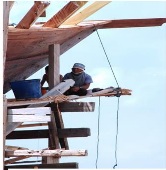
Gambar 6. Salah seorang pengrajin kapal kayu sedang bekerja diketinggian tanpa menggunakan pengamanan yang memadai ( unsafe action dan unsafe condition )
