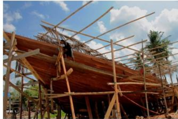
Gambar 4. System scaffolding yang rawan untuk mengerjakan pekerjaan bagian atas kapal kayu ( unsafe condition )
