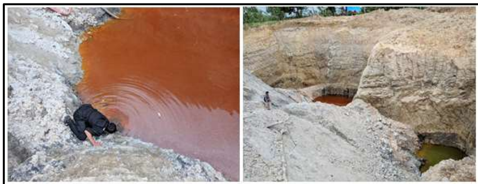
Gambar 4. Sampling Material Tanah dan Air Untuk Mengevaluasi Apakah Tanah dan Air di Daerah Tambang Berpotensi Menimbulkan Air Asam Tambang
