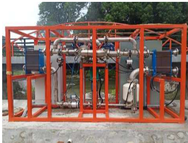
Gambar 5. Pembangkit Listrik Skala Kecil Sistem Organic Rankine Cycle (ORC)
