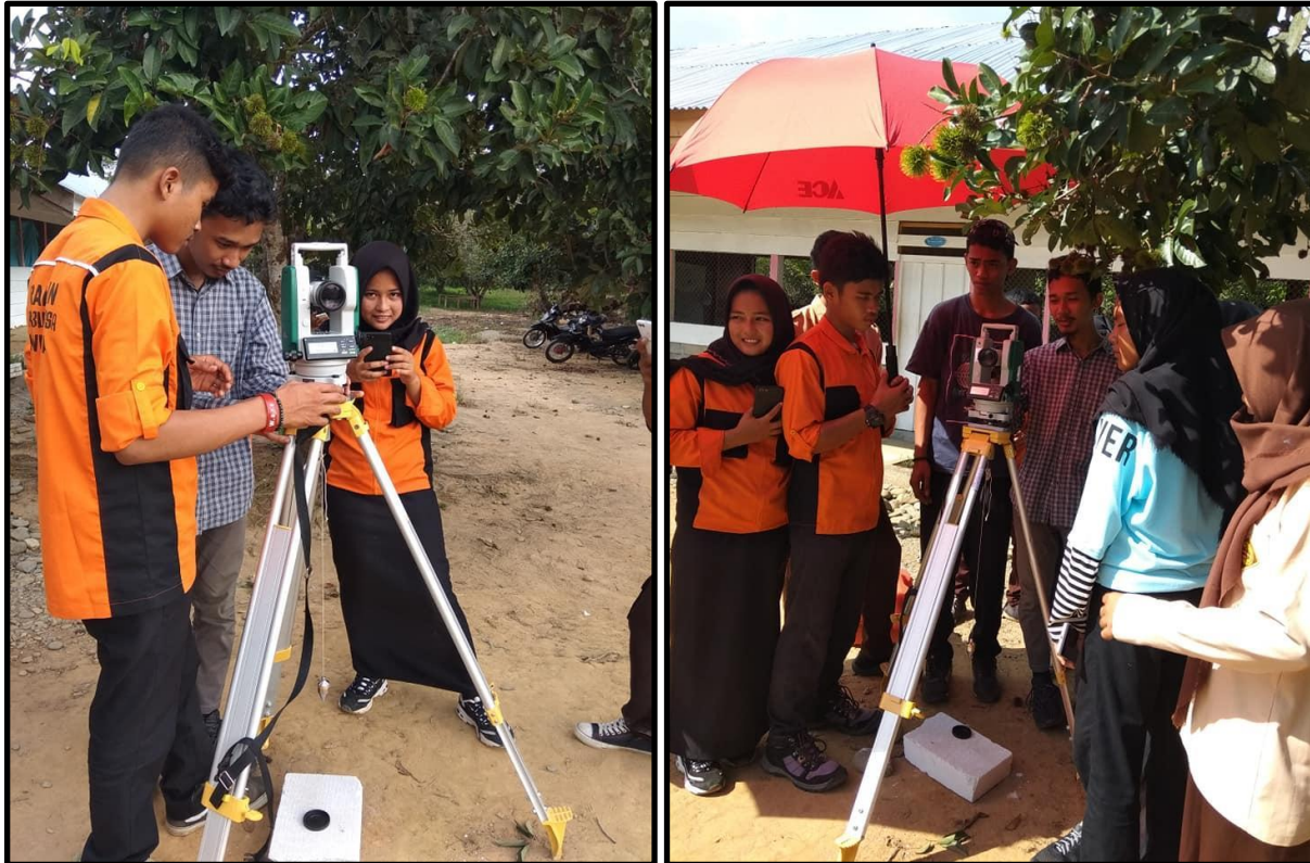
Gambar 6. Pengambilan Data Menggunakan Theodolite
