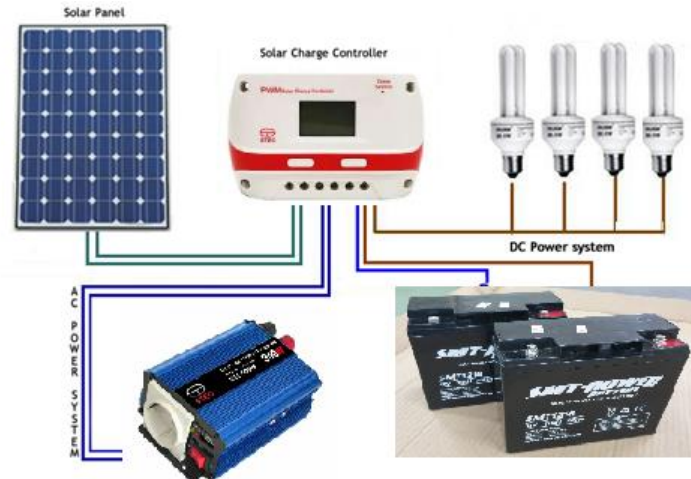
Gambar 2. Konfigurasi Sistem Sel Surya untuk Penerangan
