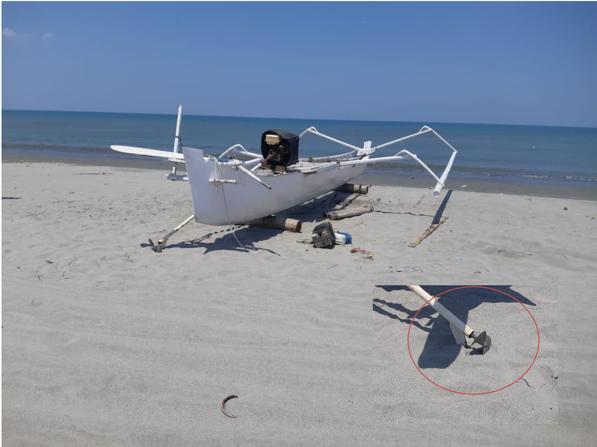
Gambar 1. Penggunaan Motor Bakar pada Kapal Nelayan Tradisional dan Sistem Propulsinya
