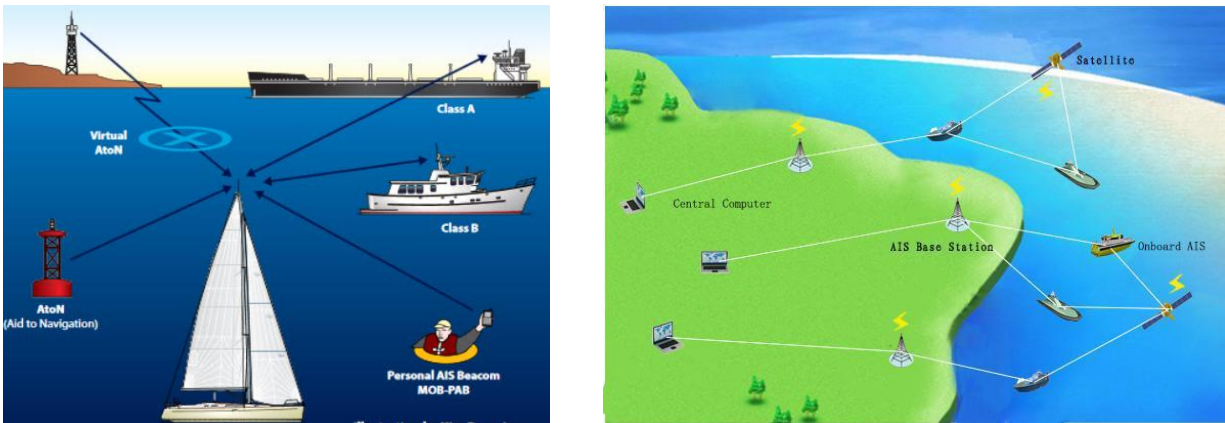
Gambar 2 Komunikasi Data AIS antara Objek Laut dan Stasiun Darat (kiri). Komunikasi Data AIS Objek Laut, Station Darat dan Satelit Geospasial (kanan)
