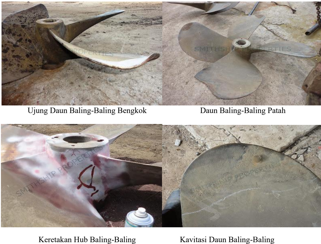
Gambar 3. Berbagai Bentuk Kerusakan Daun Baling-Baling (Boat, 2014)
