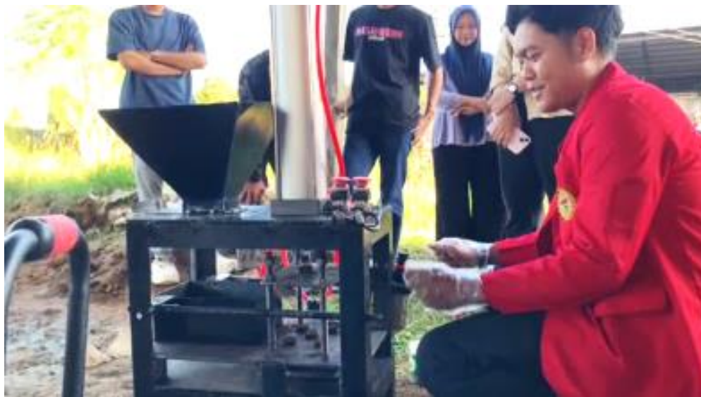
Gambar 8. Proses Pencetakan Pupuk Chickpoo
