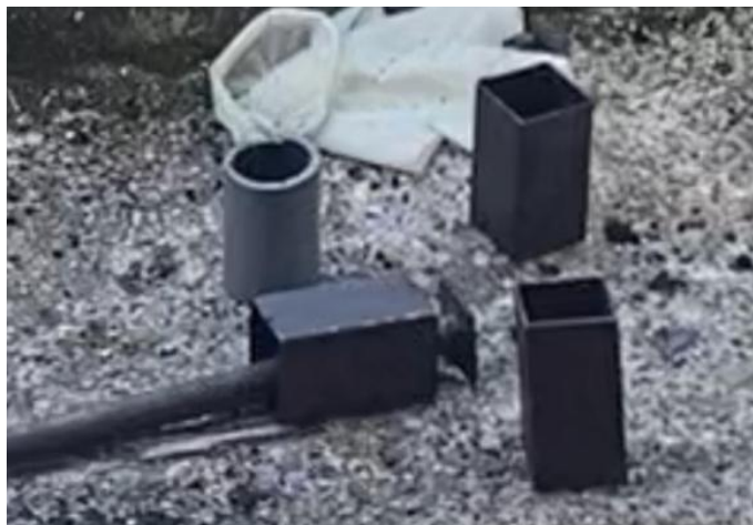
Gambar 6. Alat Pencetak Biobriket
