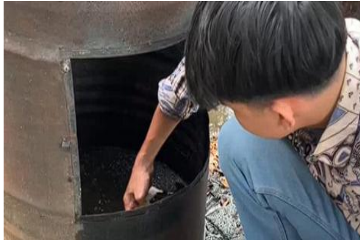
Gambar 5. Pengarangan Serbuk Kayu dengan Proses Karbonisasi
