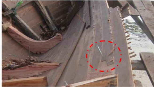
Gambar 5. Sambungan pada Kulit (Karim, A.A, 2011).
