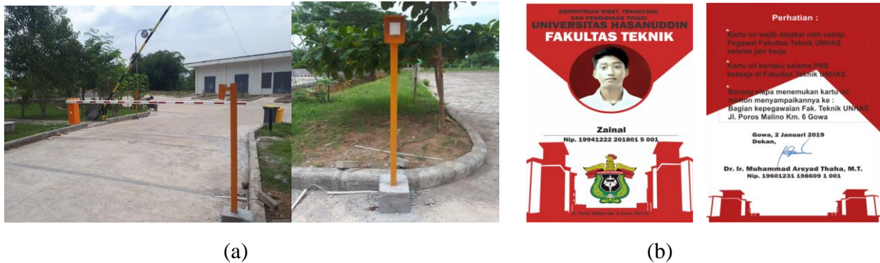
Gambar 1. Sistem Akses Lahan Parkir DTE-FTUH (a) Gateway berbasis RFID dan card Reader RFID (b) Kartu Akses Lahan Parkir RFID 125 Khz
