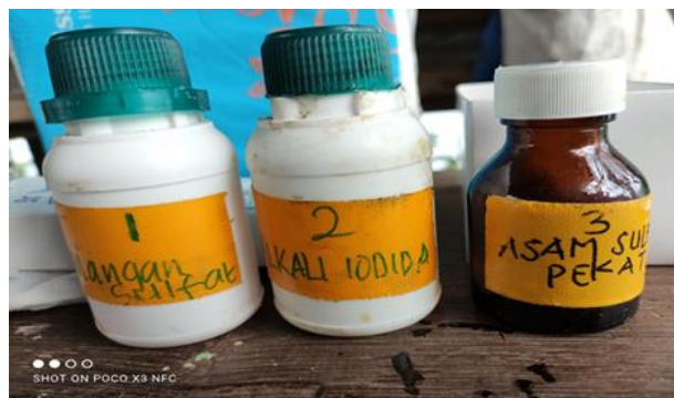
Gambar 3. Reagen-reagen kimia untuk mengikat Oksigen Terlarut (DO)
