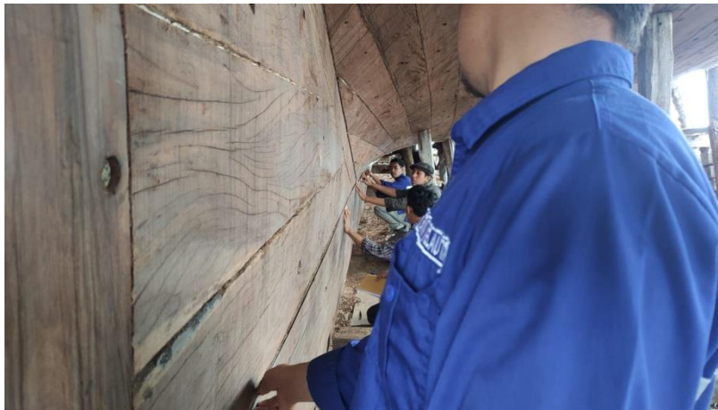
Gambar 6. Pengukuran Panjang Garis Referensi (Balok Lunas)
