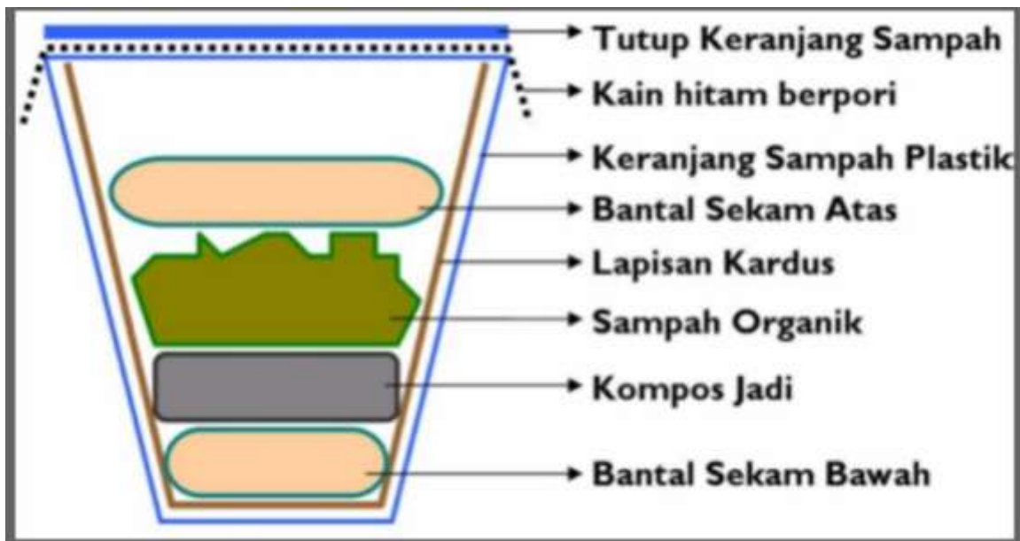
Gambar 2. Lapisan Bahan pada Keranjang Takakuta
