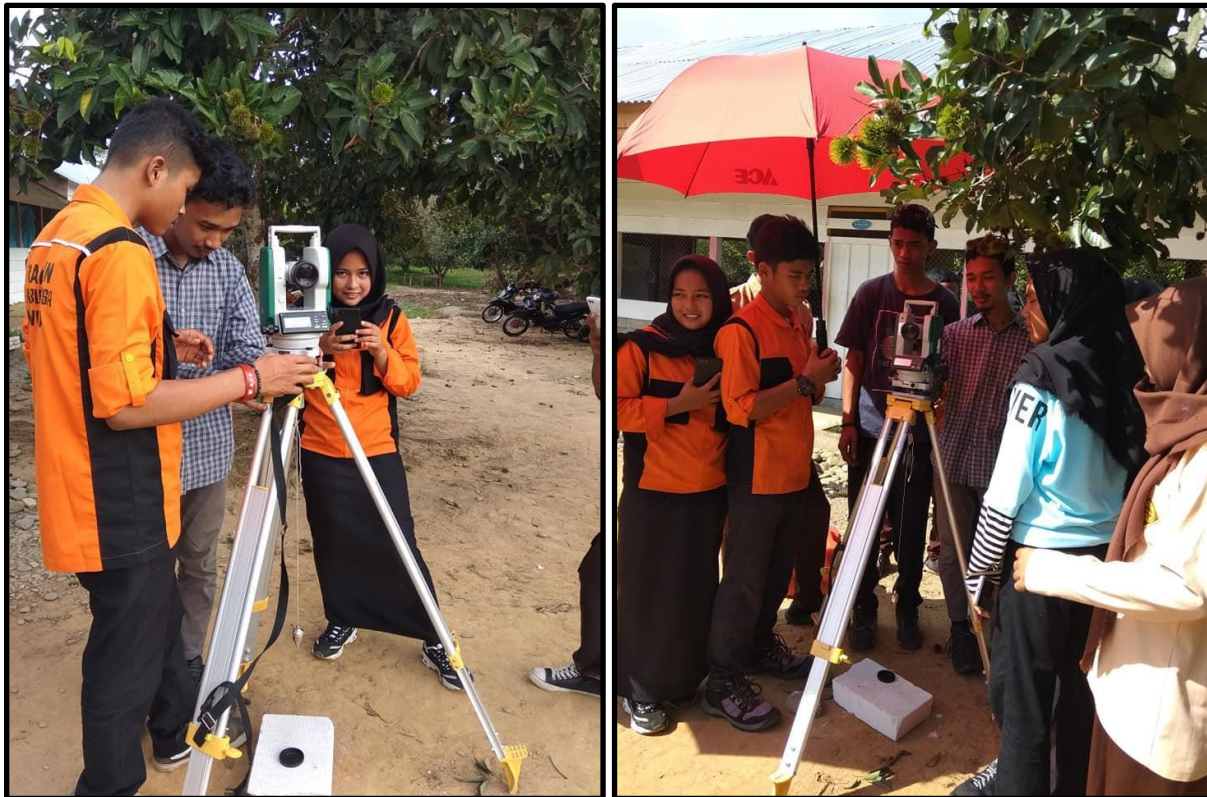
Gambar 6. Pengambilan Data Menggunakan Theodolite
