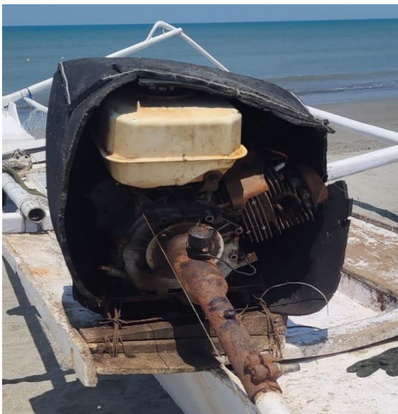
Gambar 2. Mesin Penggerak, Poros dan Baling-Baling
