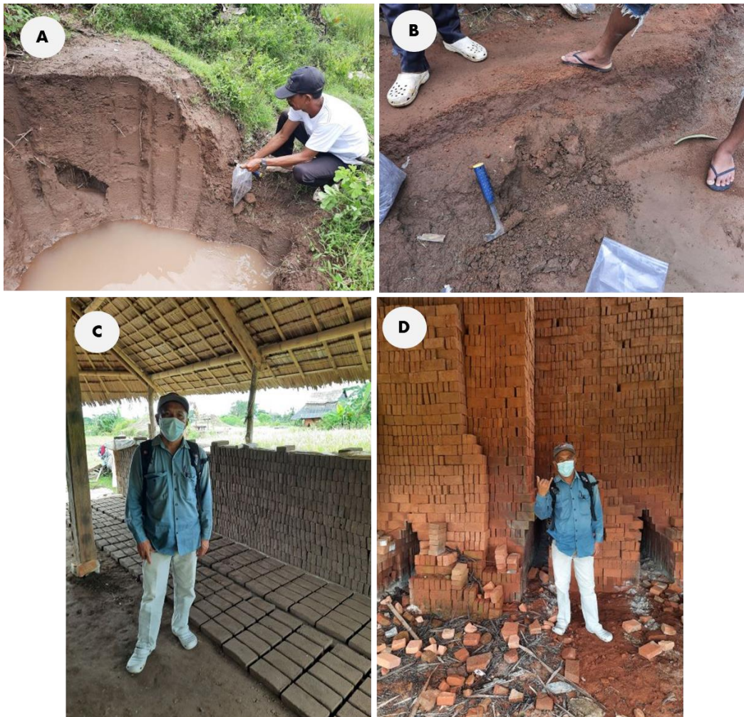
Gambar 2. Kondisi Lapangan Pembuatan Batu Bata. Penggalian Material Bahan Baku Dilakukan di Dekat Gubuk-Gubuk (A & B). Pengeringan Batu Bata yang Telah Dicetak dalam Gubuk (C) Kenampakan Batu Bata yang Telah Mengalami Pembakaran (D).
