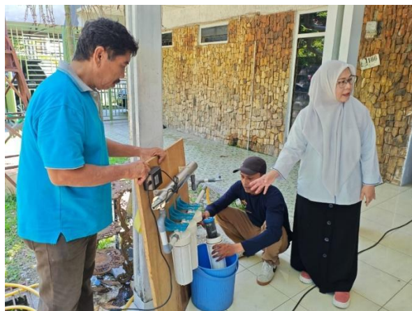
Gambar 3. Tim PkM Mendemonstrasikan Desain Penjernih Air dengan Tiga Tabung Paralel
