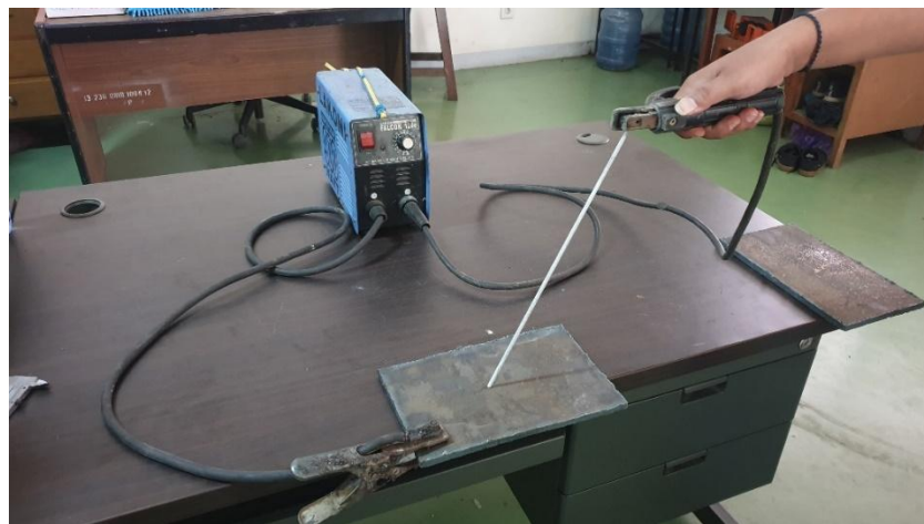
Gambar 3. Instalasi Mesin Las SMAW
