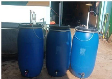
Gambar 3. Bioreaktor untuk Proses Fermentasi
