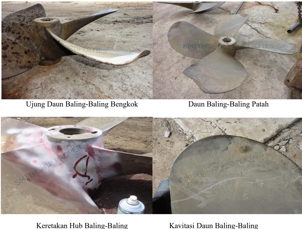
Gambar 3. Berbagai Bentuk Kerusakan Daun Baling-Baling (Boat, 2014)
