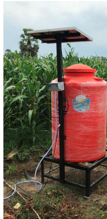
b) Prototipe pompa air tenaga matahari
