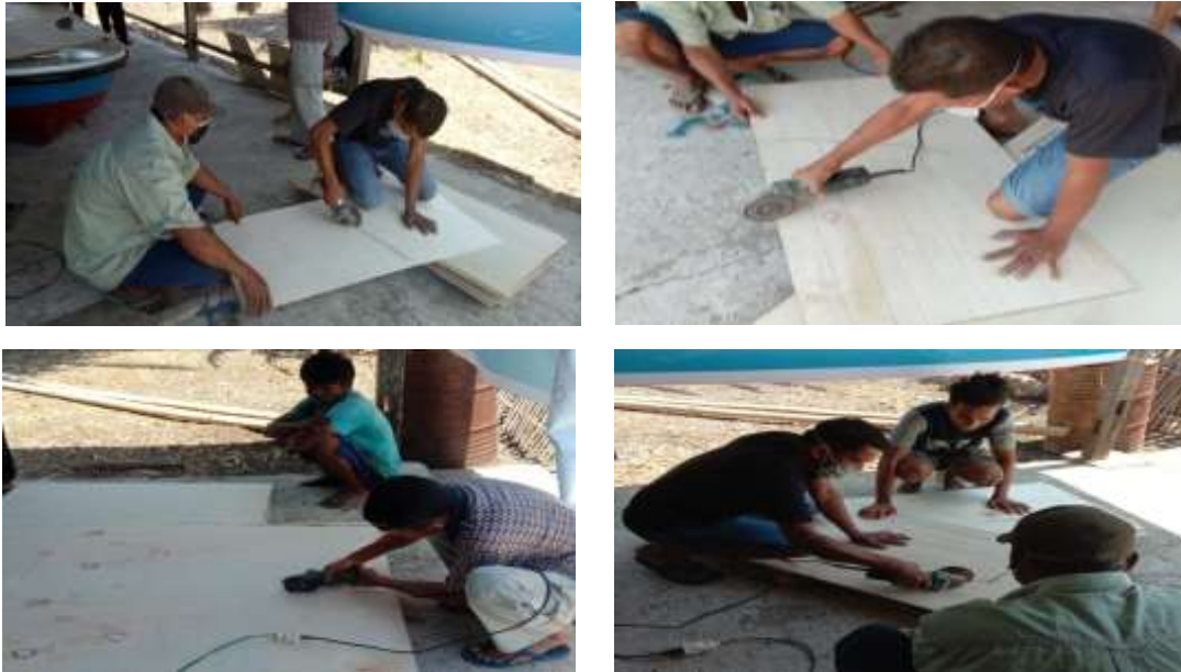
Gambar 8. Pemotongan penampang untuk cetakan Sumber: Dokumentasi tim (2019)
