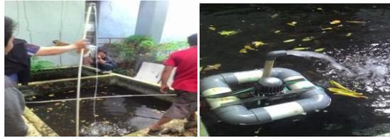
Gambar 2. Pengujian Prototipe Pompa air
